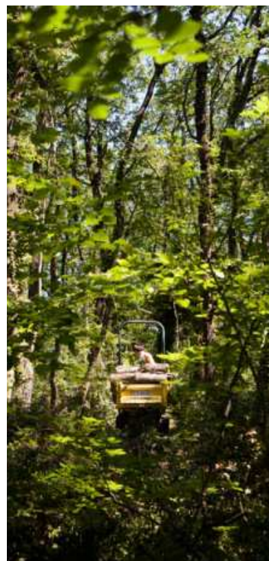
Utilisation d'une brouette à chenille avec des billons de 1 m. Faible emprise au sol et faible consommation de carburant.
